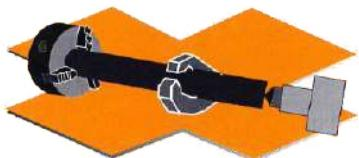
⚠ При обработке длинной заготовки поддерживайте ее с помощью центра, задней бабки или устойчивого упора.
